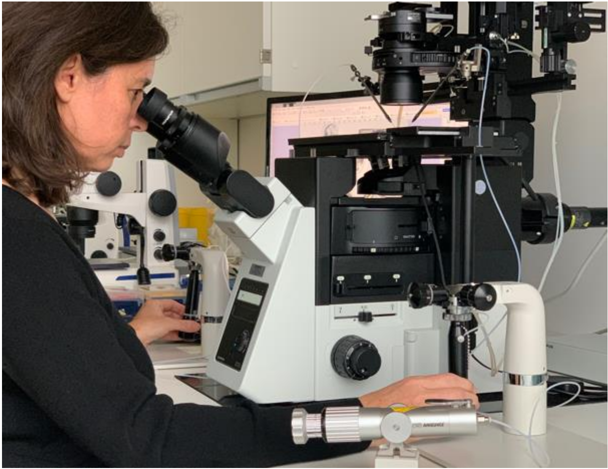
Abb. 5: Laborantin an einem Mikroskop mit Mikromanipulationseinrichtung zur Entnahme von Biopsieproben von Embryonen
